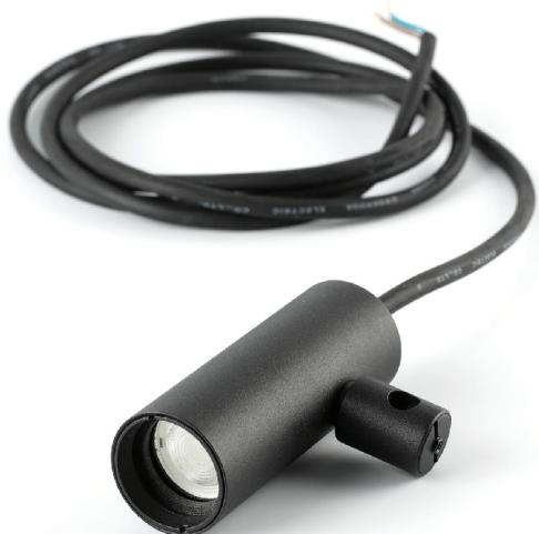
Proyector, LED 6W, cuerpo construido en aluminio terminacion negro y difusor en PMMA transparente. Incluye modulo LED 6W 2700K 38° 383lm 24V.Driver no incluido.IP 65Medidas: Ø36 x 97 x h 63 mm cable 2000 mmModelo: Clap (75702-223)
